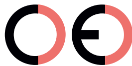
Virheellinen CE-merkki (liian kaukana)
