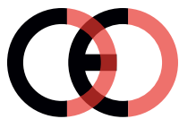
Virheellinen CE-merkki (liian lähellä)
